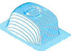
Charakteristik der mittlenbetonten Integralmessung grafisch dargestellt
